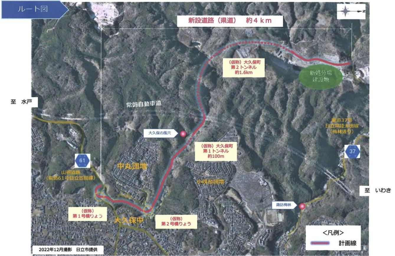
(山側道路から第1橋梁、第2橋梁、第1トンネル、第2トンネル経由で処分場に至る)
