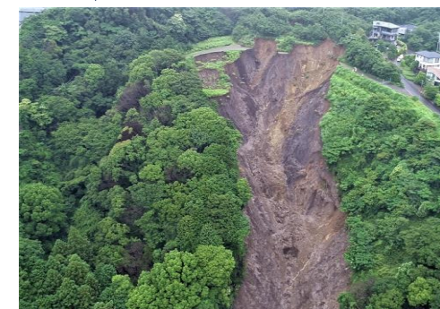
熱海の土石流 21/7 埋立て容積8万m 3 中5万m 3 が流出。 唐津沢埋立て廃棄物は240万m 3 で30倍
