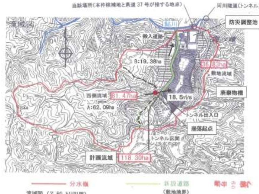
図1 流域図 この図は、県の基本計画図に一部加筆したもの。赤丸印は、上流域の下流端を示し、この位置付近で、台風13号時に、矢印方向の洪水流により地盤の大崩落が発生した。
